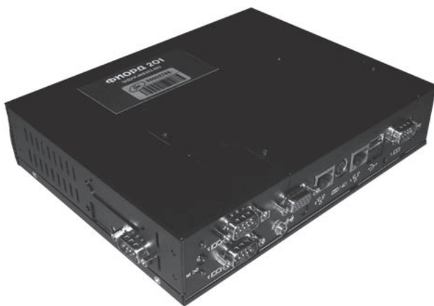
Рис. 4. Коммуникационный ISaGRAF-контроллер ФИОРД-2019 для энергетики с поддержкой протоколов IEC 60870-5-104 и Modbus RTU/TCP
