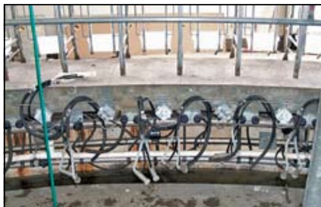
Рис. 7. ISaGRAF 5 управляет распределенной автоматизированной системой машинного доения
